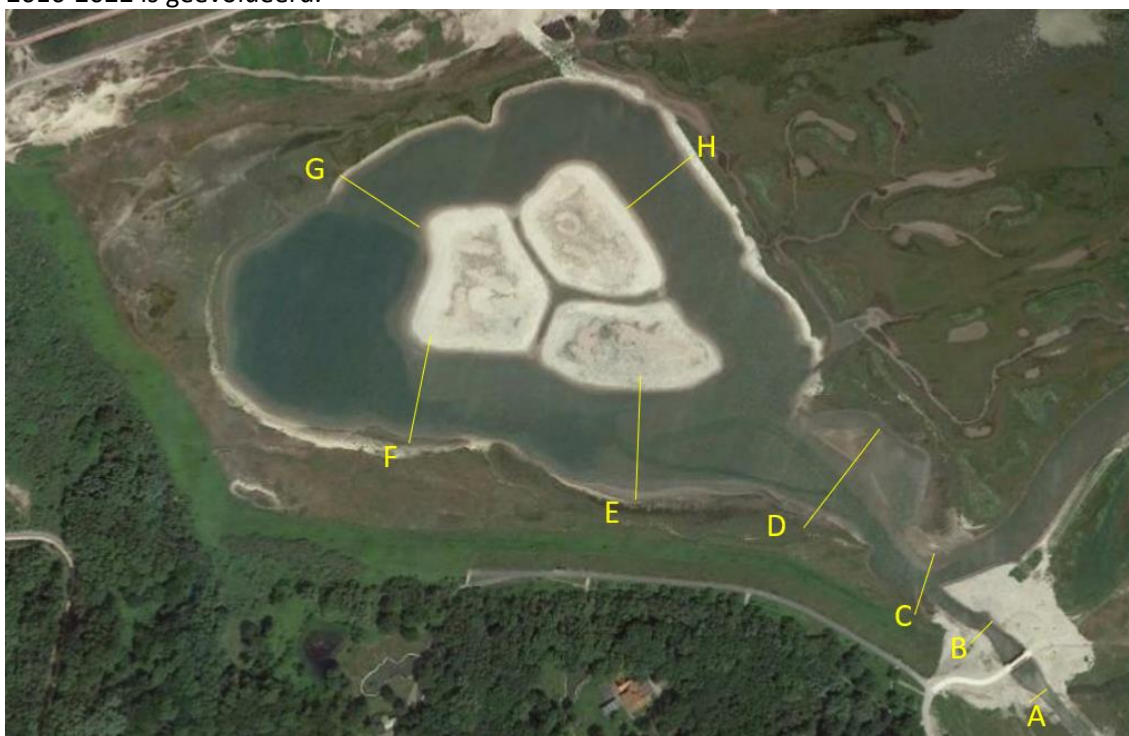
Fig. 2.17. Situering van de in totaal 8 transecten die werden uitgezet om jaarlijks de diepte te peilen in de ringgracht rond de westelijke broedvogeleilanden (E-D) en in het aan- en afvoerkanaal van het
